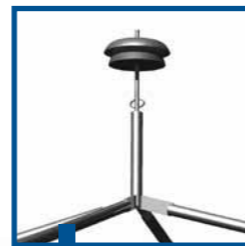
Colmo struttura e collegamento diagonali superiori (A1)
